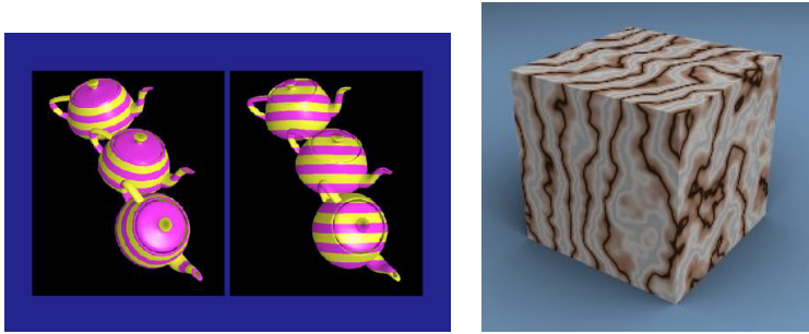
(a) Primjer volumne teksture koja je pridružena objektu, odnosno objekt se pomiče kroz fiksni prostor teksture.
